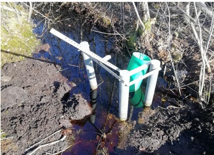
Abb. 4: Überlaufrohr mit zusätzlicher Holzkonstruktion und aufgestecktem Überlaufrohr
